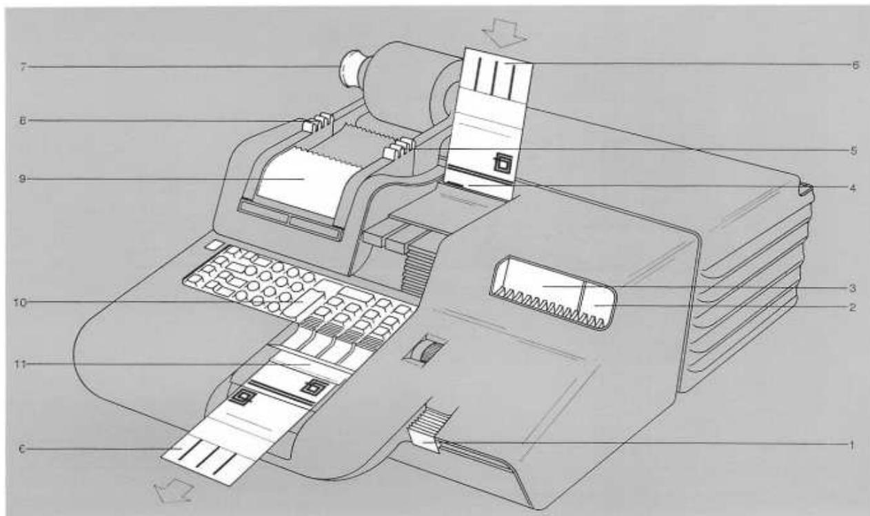
1. *Interruttore dell'alimentazione*: attiva il funzionamento della macchina; quando il calcolatore viene disattivato, tutti i dati e le istruzioni in memoria vengono annullati.
