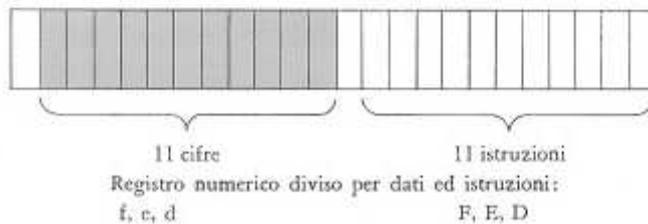
Le due parti di un registro così diviso funzionano in modo autonomo e vengono identificate:
